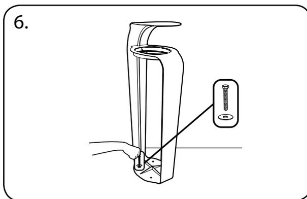
Insérer les pointes des boulons d'ancrage dans les trous de la poubelle puis dans le sol. Serrer à la main pour commencer.
