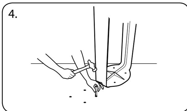
Taper avec un marteau sur les pointes des boulons d'ancrage (pièce 4) jusqu'à ce que le dessus de celles-ci soit au niveau du sol.
