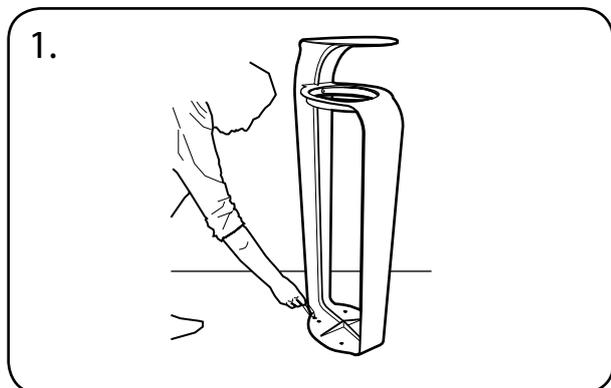
Placer la Vigi-Courbe (pièce 1). Utiliser le marqueur pour indiquer les 4 points d'ancrage dans le sol.
