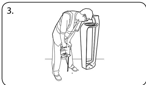
Percer les trous à une profondeur de 80 mm au moyen de la mèche de 16 mm. Évacuez la poussière des trous en brossant ou soufflant dessus.
