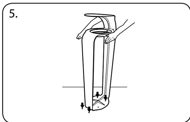
Placer la poubelle au-dessus des trous. Mettre les rondelles (pièce 3) sur les boulons (pièce 2).
