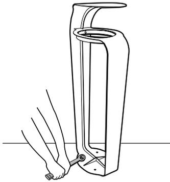
Serrer les boulons dans le sol avec une clé plate de 17 mm
